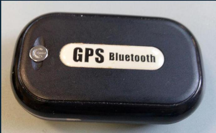
Il GPS trasmette tramite il proprio bluetooth una stringa contenente le coordinate, la data e l'ora mediante lo standard NMEA.
